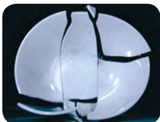
(1/2000秒の世界) 強化磁器破壊の瞬間
